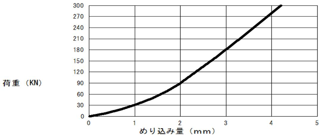
施工時にはPC鋼より線とオスコンの滑りが止まってからのめり込み量となり、最低30KN程度緊張してから残りの量を表から読み取るようになります。
